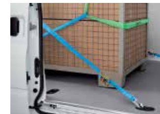
Kopflashing mit Rundschlinge
