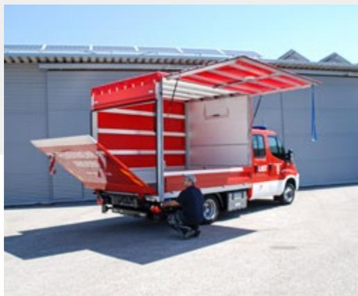
Seitenklappe wahlweise in Planen- oder Plattenbauweise
